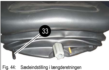
Fig. 44: Sædeindstilling i længderetningen
